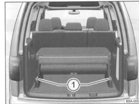
Obr. 96 Sklopení opěradla třetí řady sedadel
