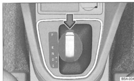
Obr. 151 Vozidlo s řízením vlevo: volicí páka převodovky s dvojitou spojkou s blokovacím tlačítkem (šipka).
