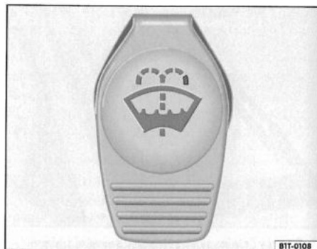
Obr. 75 Motorový prostor: uzávěr nádržky ostřikovačů
