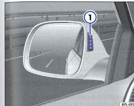
Obr. 176 Ukazatel ve vnějším zrcátku
