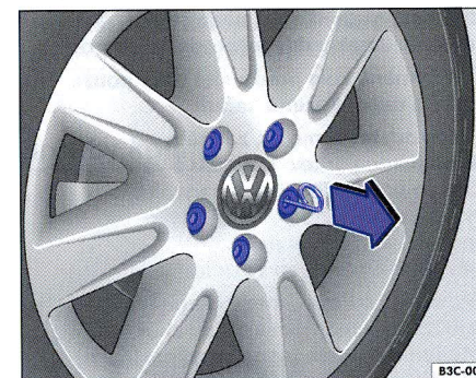
Obr. 226 Stáhnutí krytek ze šroubů kola
