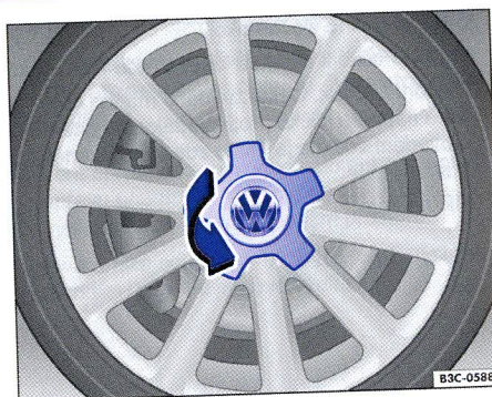
Obr. 224 Vytočte kryt středu kola
