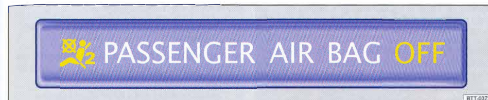
Obr. 72 Kontrolní světlo pro vypnutí airbagu spolujezdce v přístrojové desce
