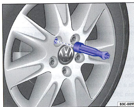
Obr. 235 Výměna kola: našroubování šroubů kol rukojetí šroubováku
