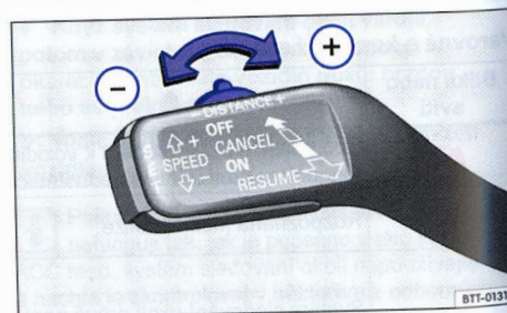
Obr. 169 Ovládací páčka ACC vpravo na sloupku řízení: nastavení stupně nastavení vzdálenosti.
