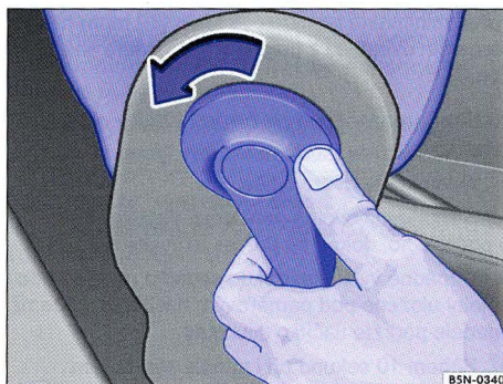
Obr. 59 Odjistění sklápěcího opěradla sedadla spolujezdce
