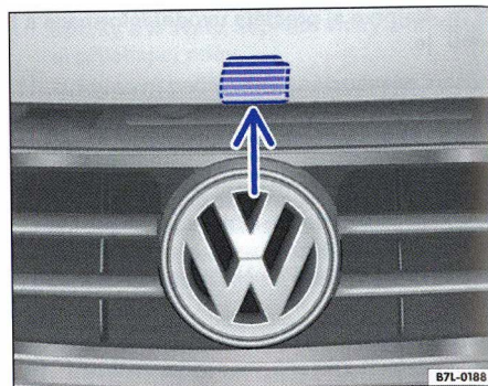
Obr. 193 Odjišťovací páčka pro otevření kapoty motorového prostoru nad mřížkou chladiče
