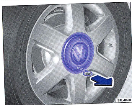
Obr. 223 Stáhnutí krytu středu kola
